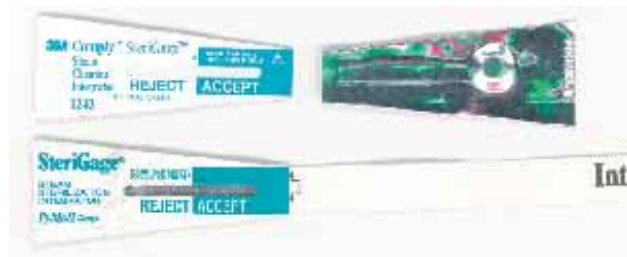
Integradores químicos de pastilla. A la izquierda, se muestra arriba un integrador sin procesar y abajo procesado con tiempo y temperatura correctos. A la derecha, se muestra el reverso con la pastilla.
