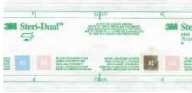
Parte de una bolsa con indicadores de exposición. A la izquierda indica que está sin procesar y a la derecha indicaría que ha sido procesado.
